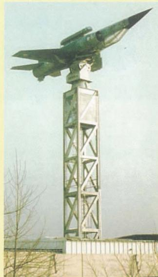
le mât monte, et l'avion se trouve porté à 16m au-dessus du toit, offrant ainsi un spectacle singulier, d'autant que, suivant les mesures à réaliser, il arrive que l'avion soit sur le dos !
